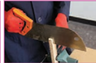
ث - اره کاری شیار بازوی چوبی
