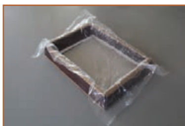
پ - قراردادن نایلون در قالب شکل ۸-۲۰ - تهیه قالب
