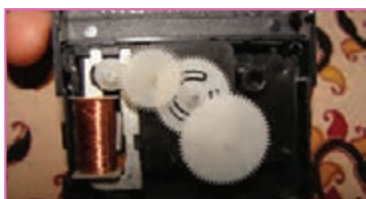
ب — بعد از باز کردن موتور ساعت
