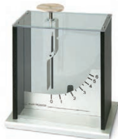
الف) تصویری از یک الکتروسکوپ ب) جسمی باردار را به کلاهک الکتروسکوپ بدون بار نزدیک کرده یا تماس داده ایم.
