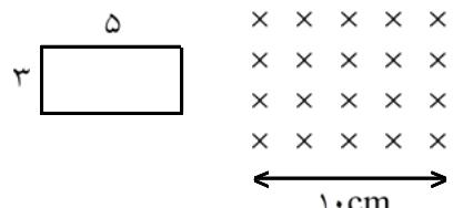
قاب در مدت  $0.025$  ثانیه وارد میدان می‌شود و در مدت  $0.025$  ثانیه از آن خارج می‌شود و در مدتی که در میدان حرکت می‌کند شار مغناطیسی ثابت و نیروی محركه برابر صفر خواهد بود.
