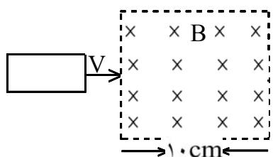
وقتی قاب با سرعت  $V$  وارد میدان مغناطیسی می‌شود، در لحظه‌ی اول  $\Phi = 0$  و وقتی به طور کامل وارد میدان می‌شود  $\Phi_2 = BA$  و هنگامی که از طرف دیگر خارج می‌شود شار مغناطیسی کم و به  $\Phi_3 = 0$  می‌رسد.
