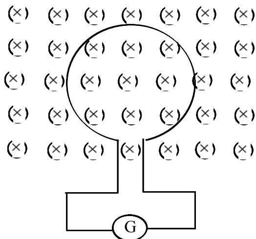
میدان مغناطیسی درون سو و حلقه عمود بر میدان مغناطیسی است. هرگاه میدان مغناطیسی درون سو افزایش یابد، شار مغناطیسی عبوری از حلقه افزایش می‌یابد و در مدار جریان القایی برقرار می‌شود که آثار مغناطیسی آن با افزایش میدان مغناطیسی مخالفت می‌کند، در این صورت جریان القایی پاد ساعتگرد می‌باشد.
