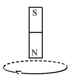
وقتی آهنربا از حلقه دور می‌شود، شار مغناطیسی در حلقه فلزی تغییر می‌کند و در آن نیروی محرکه القایی ایجاد می‌شود که باعث برقراری جریان القایی می‌گردد (قانون فارادی). جهت جریان القایی در جهتی است که آثار مغناطیسی حلقه با دور شدن آهنربا مخالفت می‌کند. هرگاه میدان مغناطیسی حلقه رو به بالا باشد، جهت جریان القایی در حلقه، مطابق شکل مقابل ساعتگرد خواهد بود (از رخ بالا).
