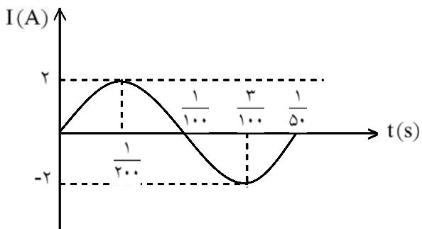
با توجه به نمودار و معادله شدت جریان - زمان در لحظه‌های  $\frac{1}{200}$  و  $\frac{3}{200}$  شدت جریان ماکزیمم است، یعنی در لحظه  $\frac{1}{200}$  برابر  $(+2A)$  و در لحظه  $\frac{3}{200}$  می‌باشد. در این مدار نیروی محرکه القایی با شدت جریان الکتریکی هم فاز است و در لحظه‌هایی که شدت جریان ماکزیمم است، نیروی محرکه‌ی القایی نیز ماکزیمم است. در روش دیگر می‌توان گفت وقتی  $\sin 100\pi t$  برابر  $(\pm 1)$  گردد، شدت جریان و نیروی محرکه‌ی القایی ماکزیمم است.
