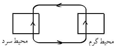
در پدیده‌ی انتقال گرما از طریق هم‌رفت جریان هوا به صورت شکل مقابل بین محیط گرم و سرد برقرار می‌شود. علت این پدیده این است که هوای سرد دارای چگالی بیشتر است و به سمت پایین حرکت می‌کند و هوای گرم دارای چگالی کم‌تر است و به سمت بالا حرکت می‌کند.
